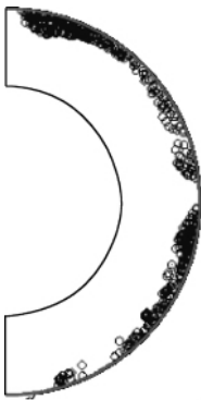
图 6 方案 a 扫气流在进口面上的分布 Fig. 6 Scavenge flow at inlet for case a
